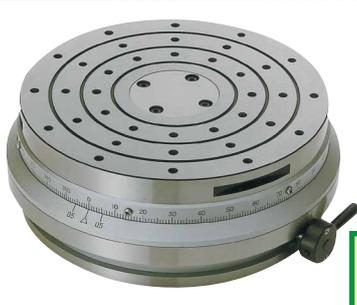
切削や研削加工時に、工作物の円周を等間隔に分割するなど、工作物の角度を割り出す装置。分度器の1目盛りの1万8千分の1という高い精度で角度を位置決めすることが高く評価され、国内外機関で角度上位標準器として採用された。第1回ものづくり日本大賞で経済産業大臣賞を受賞。
