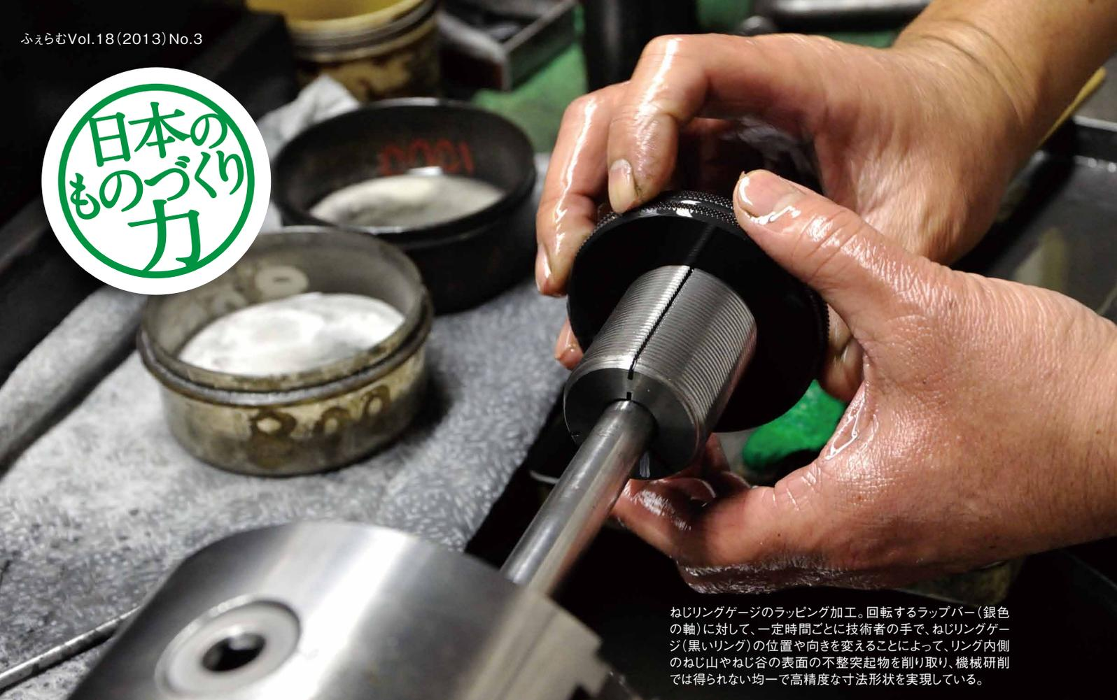
ねじリングゲージのラッピング加工。回転するラップバー（銀色の軸）に対して、一定時間ごとに技術者の手で、ねじリングゲージ（黒いリング）の位置や向きを変えることによって、リング内側のねじ山やねじ谷の表面の不整突起物を削り取り、機械研削では得られない均一で高精度な寸法形状を実現している。
