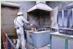
強靱なゲージ鋼を作り出す熱処理工程。焼き入れでは、強度、耐摩耗性、耐疲労性、耐食性を付加する表面改質を行う。
