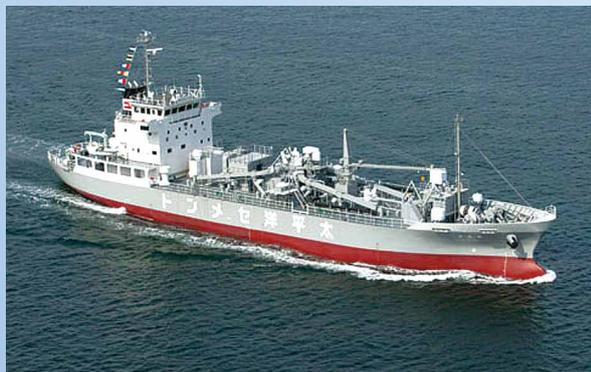
推進方式にラインシャフト二重反転方式を採用したSESとして初の749総トン型セメント船。
