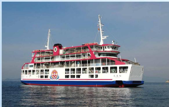
二重反転式ポッド推進器を初めて搭載した1300総トン型旅客船。
