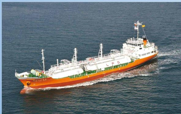
推進方式にラインシャフト二重反転方式を採用したSESとして初の749総トン型LPG船。
