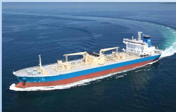
推進方式にタンデムハイブリッド方式を採用した15000総トン型セメント船。
