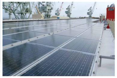
ハイブリッド自動車運搬船「EMERALD ACE」には、甲板に160kWの太陽電池が敷き詰められ、発電した電力は約2.2MWhのリチウムイオン電池に蓄えられる。
