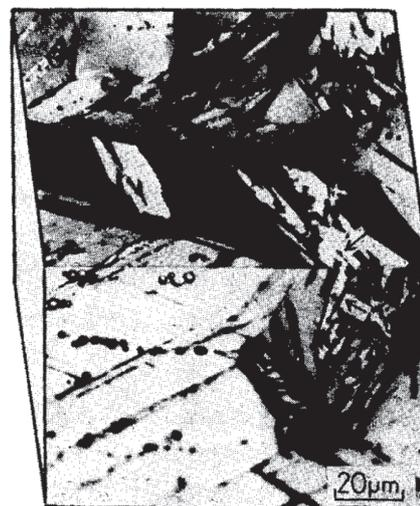
図1 2面解析の例。矢印はマルテンサイトのmid-rib<sup>4)</sup>
