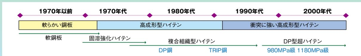
自動車用ハイテン材は、1970年代から開発が開始されている。当初は、MnやSiを添加した固溶強化型のハイテン材であったが、その後、組織中に析出物を分散させる分散強化(析出強化)と冷却制御による組織強化や靱性を高める結晶粒微細化強化などを組み合わせた複合組織型ハイテン材が開発された。硬い結晶組織と柔らかい結晶組織を分散させる複合組織を持つDP(Dual Phase)鋼は
