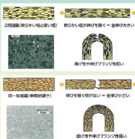
高強度と成形性(延性)を両立させるために、軟らかい組織の中に固い組織を分散させる複合組織化という手法が用いられている。局部的に大きな変形が必要なフランジ成形性や曲げ性が要求される、骨格構造材やシャシー系部材では、変形の集中を避ける事ができる均一な組織が適している。
