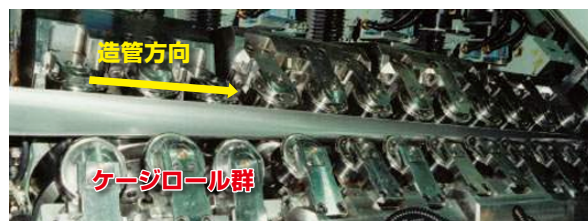
ケージロール成形域における帯板の成形状態
