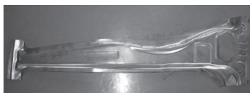
図2 高伸び型980MPa級ハイテンGAの成形例 (センターピラーモデル金型)
