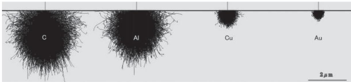
図15 15kVで加速した時のC,Al,Cu,Auに対する入射電子の侵入深さ (モンテカルロシミュレーション)
