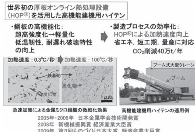
図8 HOP<sup>®</sup>適用 高機能建機用厚板ハイテン
