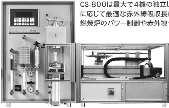
CS-800はJIS燃焼—赤外線吸収法に準拠した炭素/硫黄分析装置です。鋼、鋳鉄、銅、鉍石、セメント、セラミックスその他の材料中の炭素及び硫黄を高速同時定量します。CS-800は最大で4機の独立した赤外線セルを備えることができ、それぞれが分析用例に応じて最適な赤外線吸収長に設定されます。16ビットマイクロプロセッサにより誘導燃焼炉のパワー制御や赤外線セル検出器のゼロ及び感度調整を行います。
