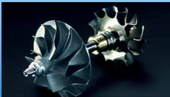
ガソリンエンジンでは精密鑄造により製造された軽量のチタンアルミ合金タービンホイールを採用している例もある。 (写真提供:三菱自動車工業(株))
