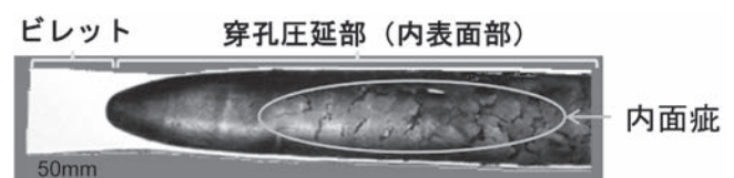
図9 Ni合金(25%Cr-32%Ni-3%Mo)の内面疵の例(モデル穿孔圧延途中止め材)
