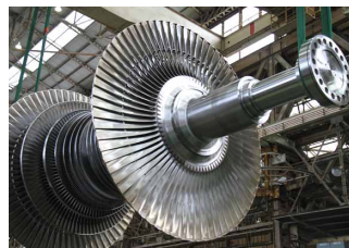
超々臨界圧火力発電用蒸気タービン (写真提供：(株)日立製作所)
