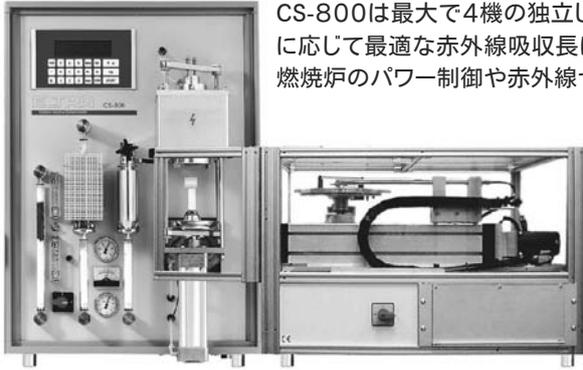
CS-800はJIS燃焼一赤外線吸収法に準拠した炭素/硫黄分析装置です。鋼、鋳鉄、銅、鉍石、セメント、セラミックスその他の材料中の炭素及び硫黄を高速同時定量します。CS-800は最大で4機の独立した赤外線セルを備えることができ、それぞれが分析用例に応じて最適な赤外線吸収長に設定されます。16ビットマイクロプロセッサにより誘導燃焼炉のパワー制御や赤外線セル検出器のゼロ及び感度調整を行います。
