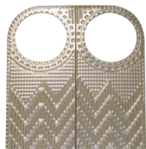
チタン製プレートのプレス成形例 (資料提供:佐賀大学海洋エネルギー研究センター)
