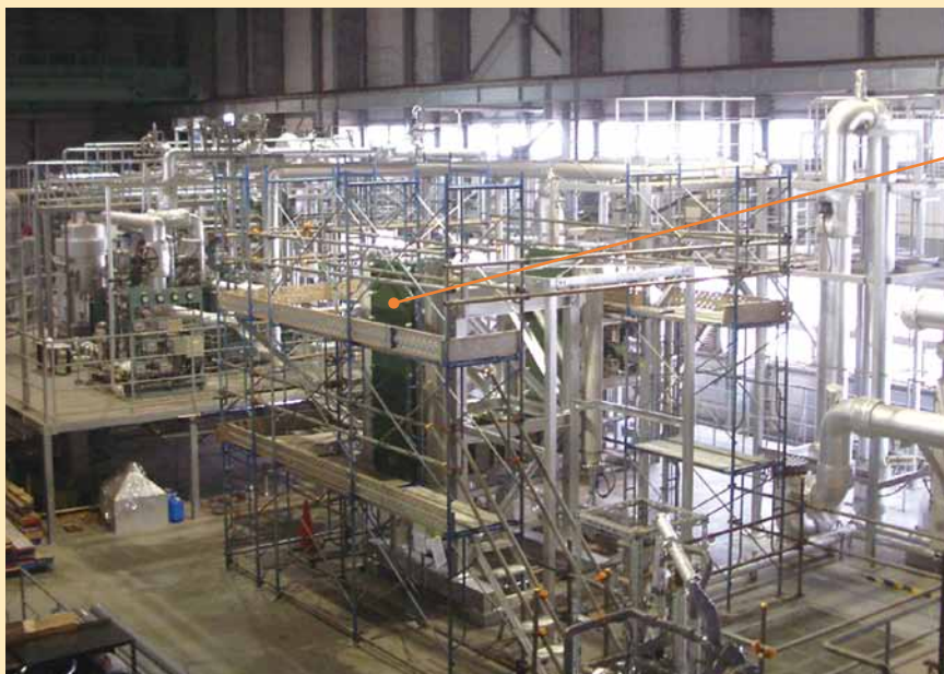
OTEC基礎実験装置(出力30kW)(左)とプレート式熱交換器(右)。緑色の装置がプレート式熱交換器であり、内部にはチタン製熱交換器プレート26枚が積層されている。
