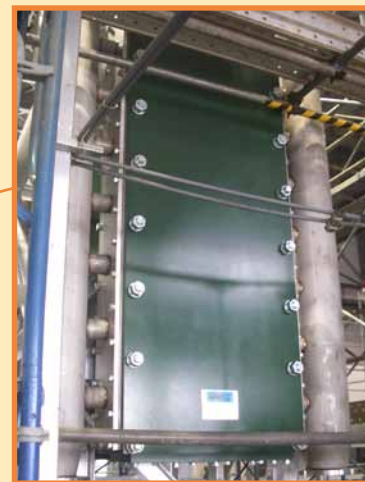
OTEC基礎実験装置(出力30kW)(左)とプレート式熱交換器(右)。緑色の装置がプレート式熱交換器であり、内部にはチタン製熱交換器プレート26枚が積層されている。
