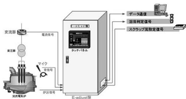
図 E-adjust機器構成例
