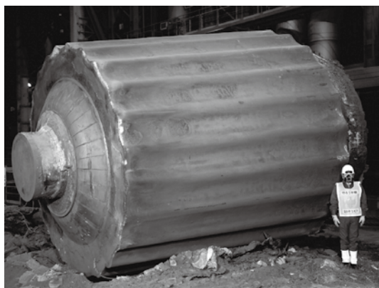
図3 世界最大の670ton鋼塊
