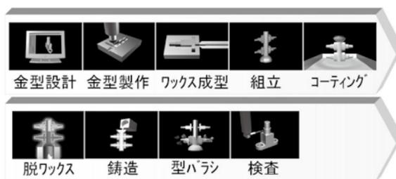
図1 精密鑄造法の製造工程
