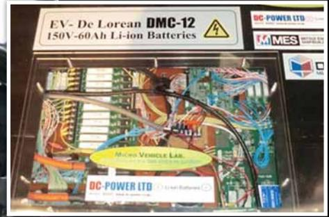
リン酸鉄リチウムを正極に使用したリチウムイオン二次電池
