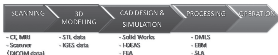
図2 医療分野における積層造形プロセスの例
