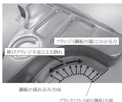
図1 伸びフランジ成形性不足による高張力合金化溶融亜鉛めっき鋼板のプレス割れ事例
