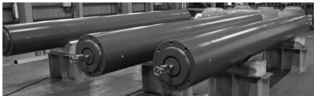
図 300リットル鋼製水素蓄圧器
