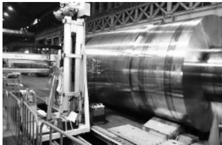
図2 自動UT装置による探傷
