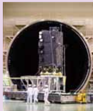
筑波宇宙センターで行われた 月周回衛星「かぐや」の熱真空試験 ©JAXA
