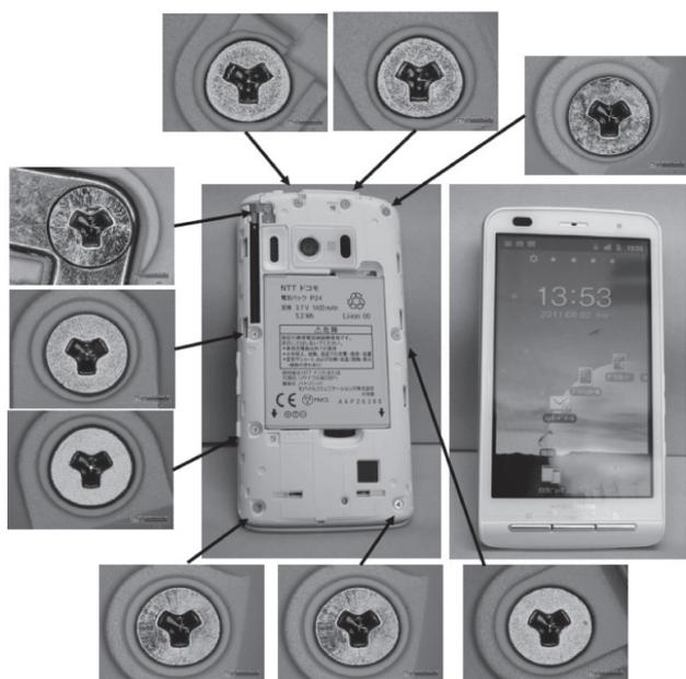
図13 スマートフォンに採用された超微細粒組織を持つM1.6高強度精密ねじ
