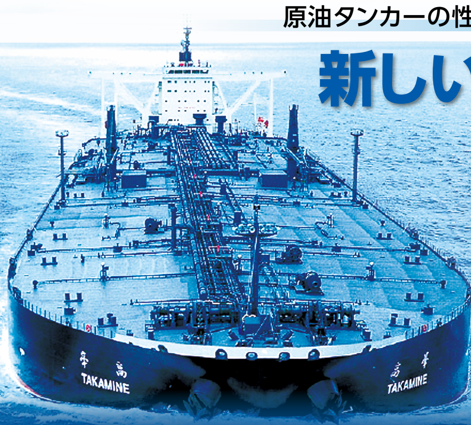
2004年に就航した、世界で初めて耐食鋼を採用したタンカー「TAKAMINE」。 積載重量約30 万t、全長333 m、幅60 m。 (写真提供: 日本郵船(株))
