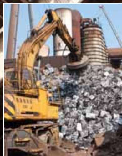
製鉄所内のリサイクルに利用されるシャフト炉(左)と鉄スクラップ(右)
