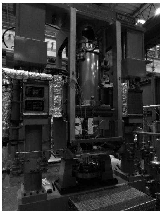
図2 140MPa級 高圧水素雰囲気下機械特性試験装置外観
