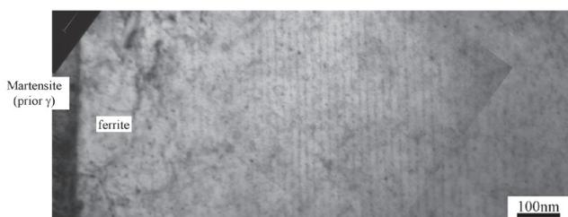
図1 0.5%V添加中炭素鋼中の $\alpha/\gamma$ 界面近傍の相界面析出状態のTEM観察結果
