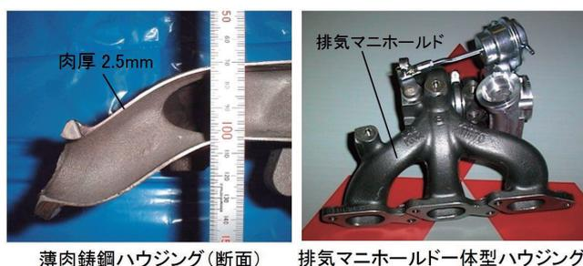
図13 鋳鋼製タービンハウジング
