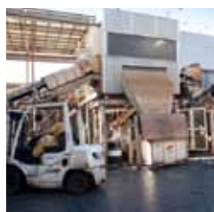
磁力選別により、鉄スクラップが選別・回収される。
