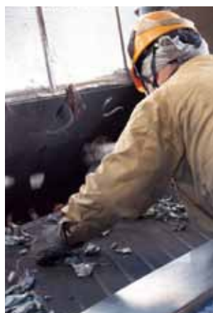
磁力選別により、鉄スクラップが選別・回収される。
