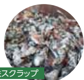
磁力選別により、鉄スクラップが選別・回収される。
