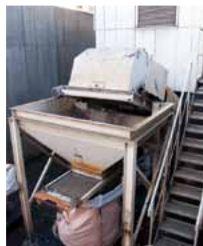
残ったスクラップ(非鉄金属混合物)はふるいにかける。
