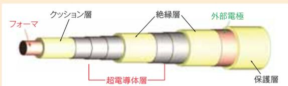
同軸ケーブルの構造を採っており、中心に支持体である銅製の「フォーマ」があり、クッション層、3層の超電導体層、絶縁層、2層の超電導体層、と層状の構造になっている。(資料提供: 中部大学)
