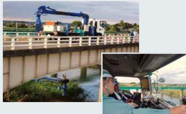
車載型のロボットシステムであり、操作室内の3DCGとモニターによる遠隔操作で、橋梁上下部などの近接目視点検を行う。画像データや位置情報は電子データ化され自動的にデータベースへ整理される。(写真右)操作室内の状況。((株)帝国設計事務所、(株)カナモトの共同開発)
