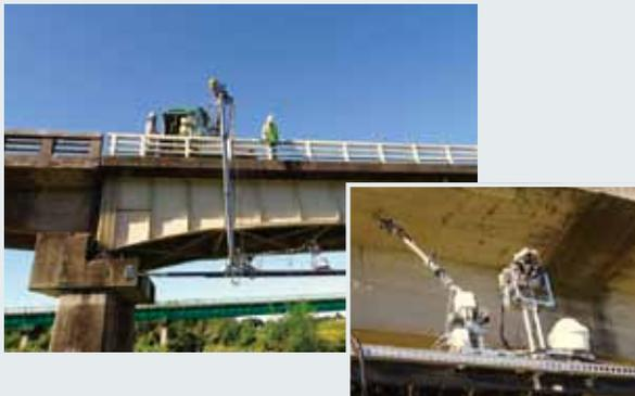
橋梁点検の近接目視の援助・補完技術として開発され、橋面上から4Kビデオカメラを搭載したアームを橋の下面に挿入し高精細なライブ映像より近接目視点検を行う。幅員が狭い橋梁でも通行規制幅が少なく抑えられる。(写真右)アーム先端部。(ジビル調査設計(株)、(有)インテス、福井大学の共同開発)
