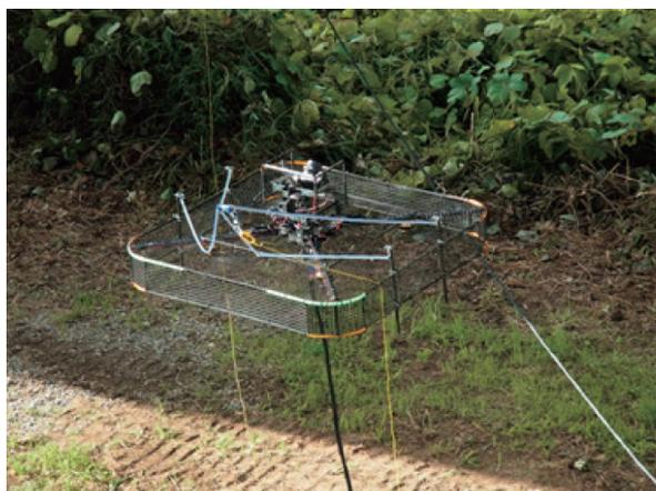
図4 高精細画像取得型マルチコプタの外観
