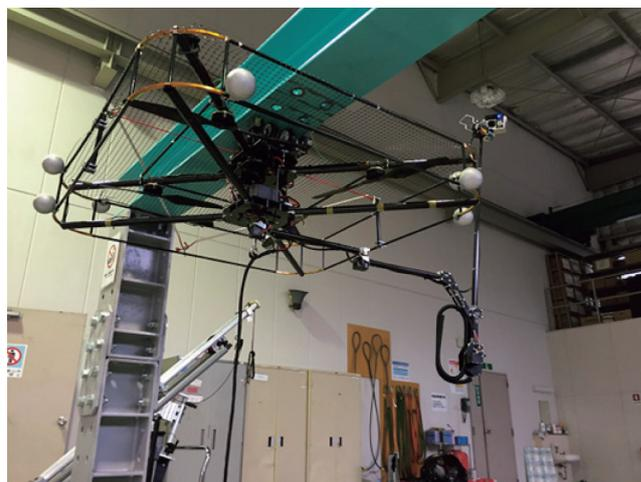
図7 橋梁脱着型マルチコプタの外観
