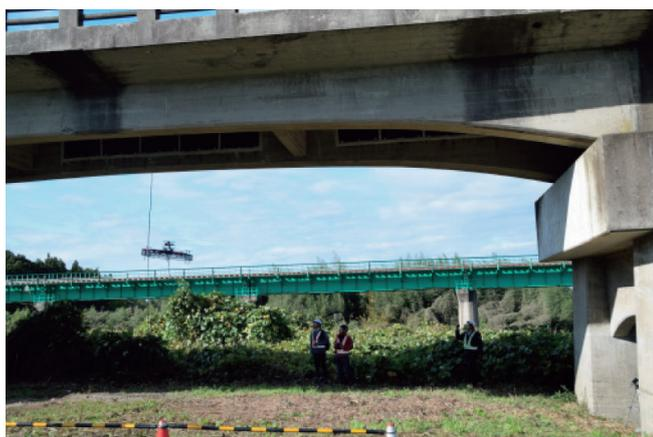
図5 試験の様子 (高精細画像取得用マルチコプタ)
