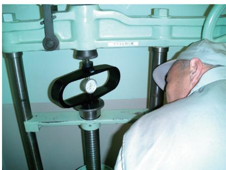
図6 専門家によるブリネル硬さ試験機の直接検証
