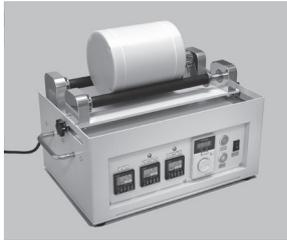
MF-1HLは、回転タイマーで希望時間をセットしておく、高速と低速回転を自動的に繰返し、設定した時間まで運転する卓上ボールミルです。試料を通常回転で乾式/湿式の粉碎、混合、分散などを行った後、極低速で回転させておくことで、試料の比重などによる分離、沈澱、凝固を防げます。回転数は高低2段階にそれぞれ変えられ、固定する事も可能です。ローラーは耐久性に優れた合成ゴム製です。
