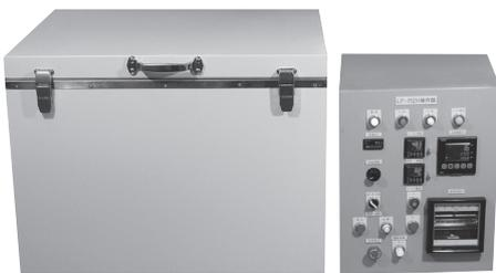
本装置は、常温での粉碎は勿論のこと230~250℃に加熱しながらの粉碎実験が行える遊星回転ボールミルです。付属のコントロールパネルにて温度調節、回転数、粉碎時間などの設定が出来、更に粉碎時の加熱状況を記録するための温度記録計と、運転中に重量のアンバランスによる異常振動を感知し自動停止させるためのセンサーが内蔵されています。
