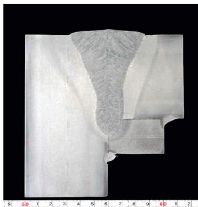
図7 マクロ試験結果（SAW溶接）
