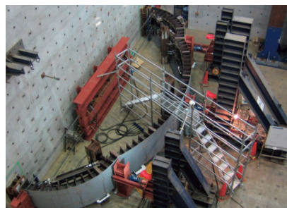
写真11 拡幅セグメント部1/2スケール載荷試験
