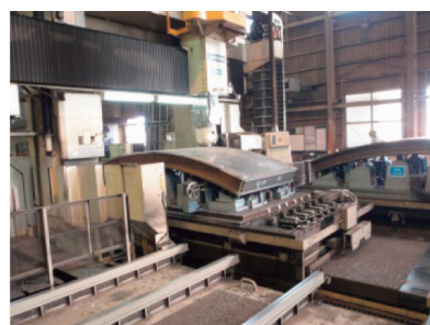
図5 6面鋼殻と特殊鋼殻による複合リング構造と躯体完成状況
