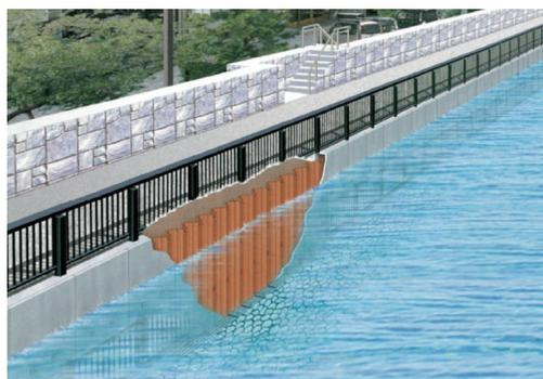
図14 鋼矢板修景工法
