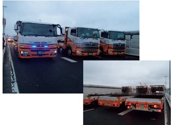
写真5 実橋載荷試験状況
