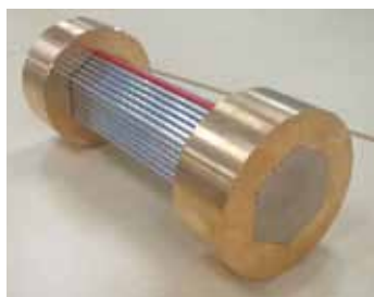
亜鉛めっき鋼線127本で構成されている。 (写真提供:東京製鋼(株))
