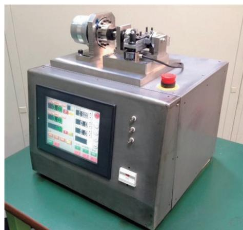
図5 荷重制御型平面曲げ式疲労試験機
