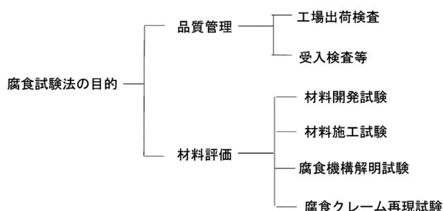
図2 腐食試験の使用目的の分類<sup>3)</sup>
