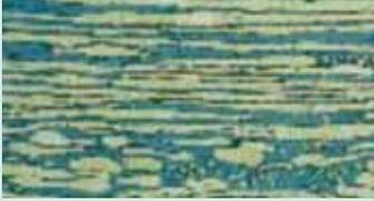
高クロム鋼に適量のニッケルを添加することにより、オーステナイトとフェライトの二相が混合した組織を持つステンレス鋼を開発した。
