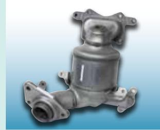
排気系部品であるコンバータケースでは、従来はカップ形状を分割し、それぞれの部材をステンレス鋼薄板でプレス成形して曲面形状を作り、溶接組立していた。この開発鋼は加工性が優れているため、分割することなく一体でプレス成形することができ、自動車部品メーカーの部品点数削減、溶接工数低減に寄与することができた。
