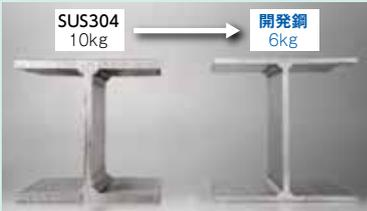
同等の強度を持つH形鋼の重量を比較した場合、SUS304は10kgに対し、開発鋼は6kgで、45%程度の軽量化が図れる。耐食性を保ちつつ軽量化と材料コスト削減を実現し、プラント設備やケミカルタンカー部材などに適用されている。
