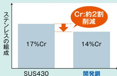
レアメタルのクロムを節減するため、開発鋼では微量のスズを添加した。これによりSUS430(17%クロム)と比較して開発鋼(14%クロム-スズ)はクロムを約2割削減することができた。
