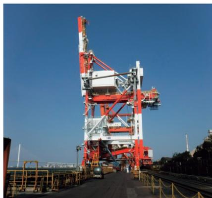
図2 新日鐵住金名古屋製鐵所に新設したアンローダー(港湾荷役機械)
