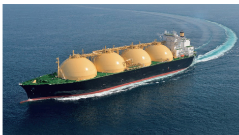
図4 高強度厚鋼板が適用されたMOSS型LNG船 (写真提供：川崎重工業株式会社)
