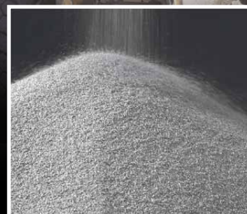
水アトマイズ法により製造された鉄粉
