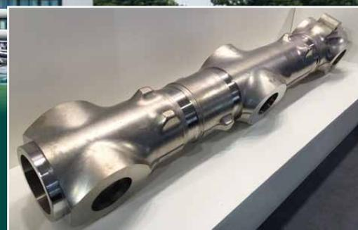
A350XWB向けに、日本初となるランディングギア用チタン大型鍛造品が採用された。(資料提供: (株) 神戸製鋼所)
