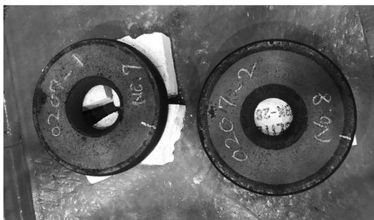
図8 摩擦実験における条件の違いによる形状変化
