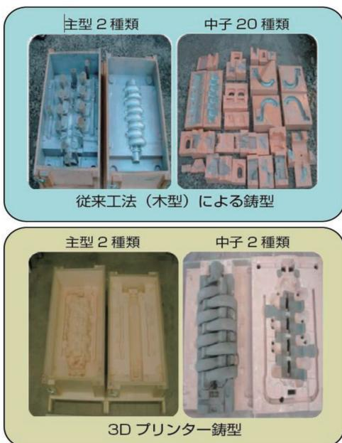
図11 3Dプリンターによる鋳型の一体造型
