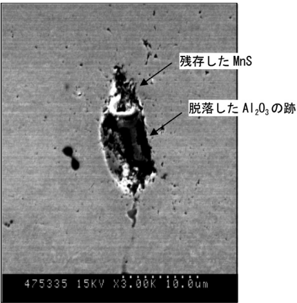
図4 PX5 のピンホール
