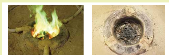
銅製錬・鉄鉱石投入炉(左)と操業後(右)の様子
