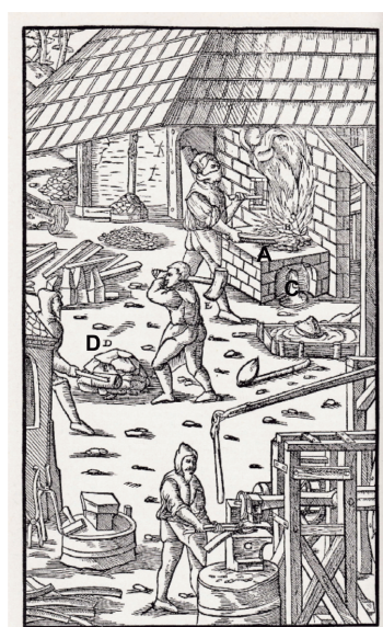
レン炉 (A) スラグ (C) 低炭素鋼塊ルッペ (D)
