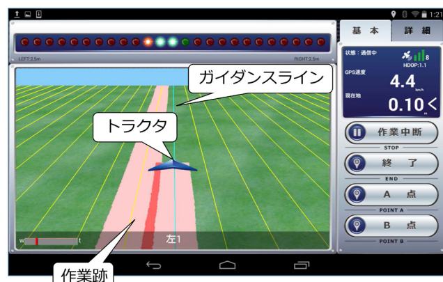
図11 GPS ガイダンス「リードアイ」
